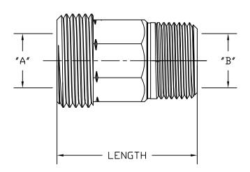
MATERIAL: NO LEAD CAST BRASS ALLOY C89833
